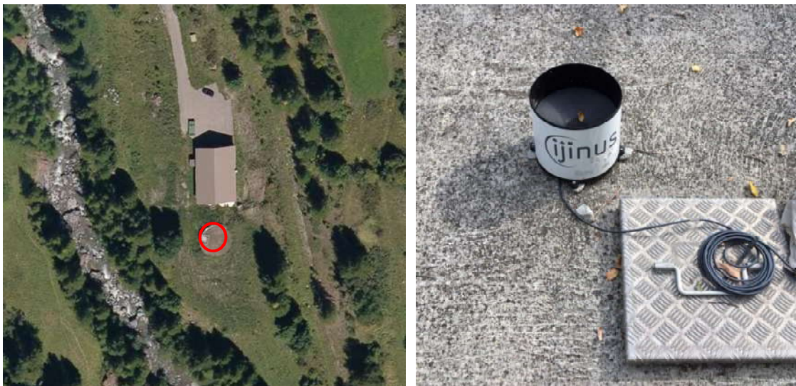
Figure 46 : Implantation du pluviomètre (rond rouge) et matériel utilisé
